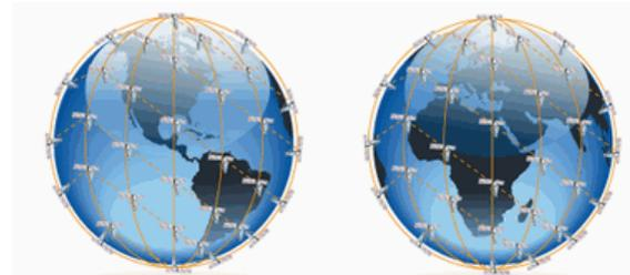
Иридиум на низкоорбитальных спутниках обеспечивает 100% покрытием территории земного шара, включая полюса.
