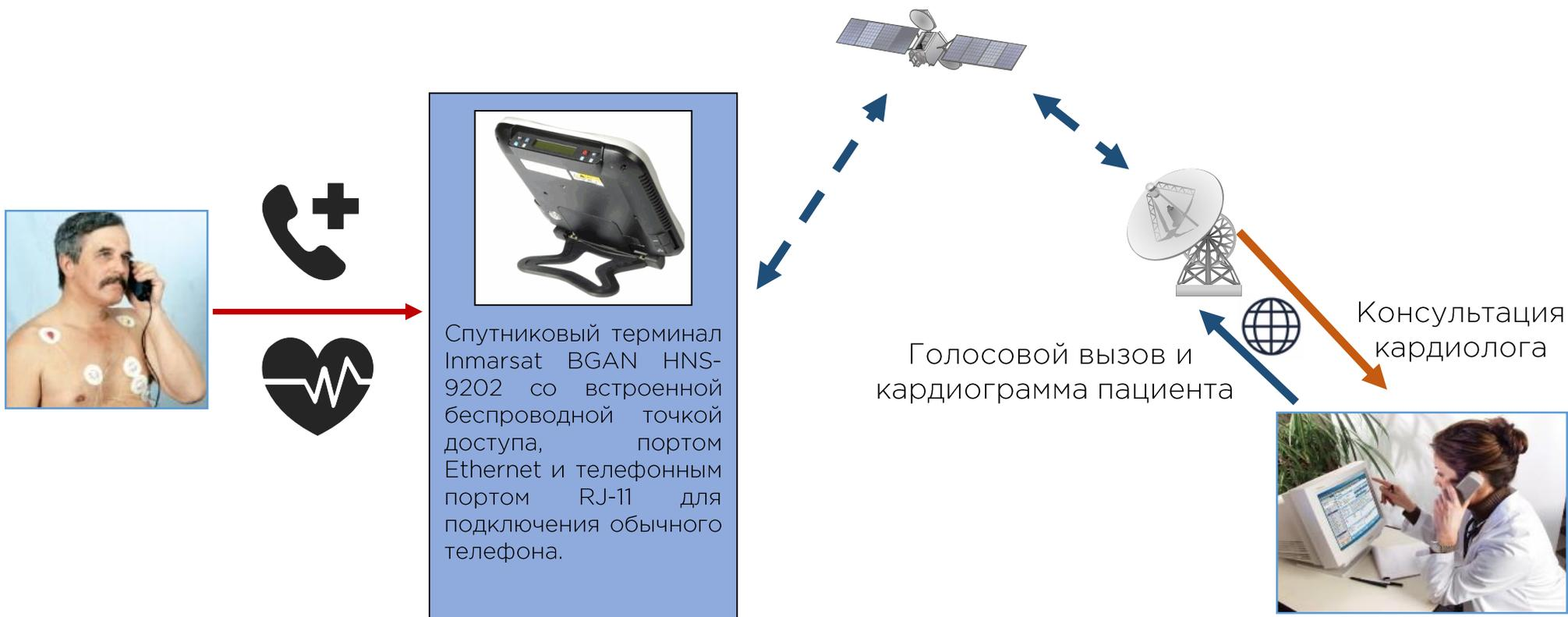
Акустическая передача кардиологических данных и организация срочной консультации специалиста по спутниковому телефонному каналу системы Инмарсат BroadBand (режим 3.1 кГц Аудио)
