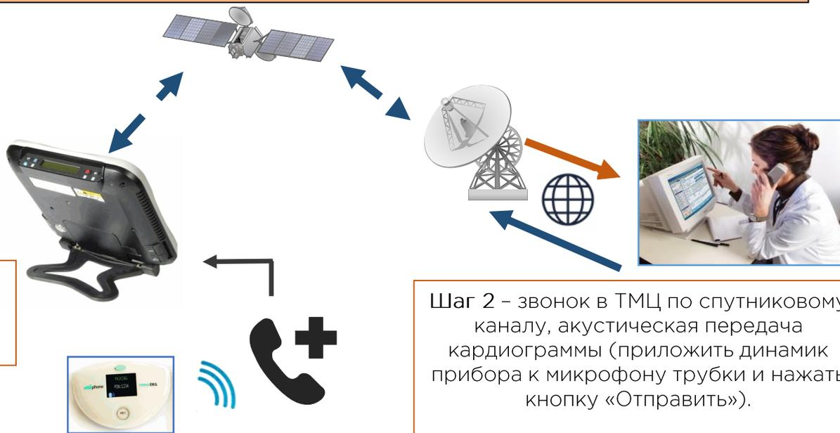
Шаг 2 – звонок в ТМЦ по спутниковому каналу, акустическая передача кардиограммы (приложить динамик прибора к микрофону трубки и нажать кнопку «Отправить»).
